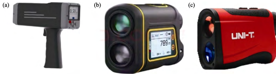
图2 数据采集设备：(a) 测量河流流速用的RD-60手持式电波（雷达）流速仪； (b) 和 (c) 测量水面宽度、洪泛平原宽度的两种测距仪
