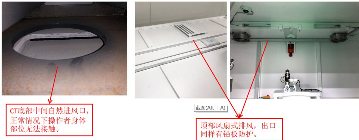
图 10-5 工业 CT 设备通风防护设计示意图
